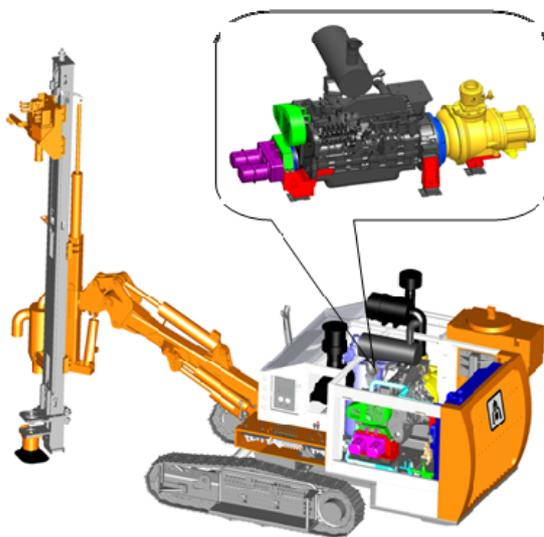
①节能：单台发动机同时驱动螺杆式空气压缩机和液压系统且设计为功率的错峰输出，相比分体式钻机加空压机，动力的总功率下降约30%，保养费用下降约50%。
