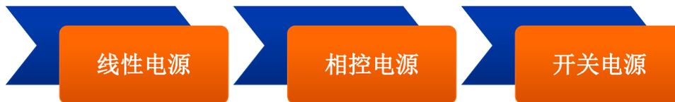
随着技术的发展，开关电源经历了从硬开关技术到软开关技术的转变。软开关技术已经成为功率变换技术的主流发展方向。软开关技术具有可靠性高、效率高、电磁干扰小等特点。目前软开关技术在高频开关电源中的应用已相当成熟，代表性的技术有相移软开关技术和谐振式软开关技术。相移软开关技术可实现一定负载范围内的软开关，但其在轻载时无法保证软开关，重载时存在占空比丢失现象。谐振式软开关技术可实现谐振电路主拓扑的软开关，但存在控制难度大、稳定性不足，难以实现产品化的缺点。“谐振电压控制型功率变换器”技术提供了一种以输出电压为外环，以谐振电压为内环的双环控制模式，实现了谐振式功率变换主拓扑的全程软开关，大幅提升了产品的转换效率、功率密度和可靠性。该技术的成功应用使得谐振式软开关电源产品在实际应用中稳定性、可靠性更高，引
