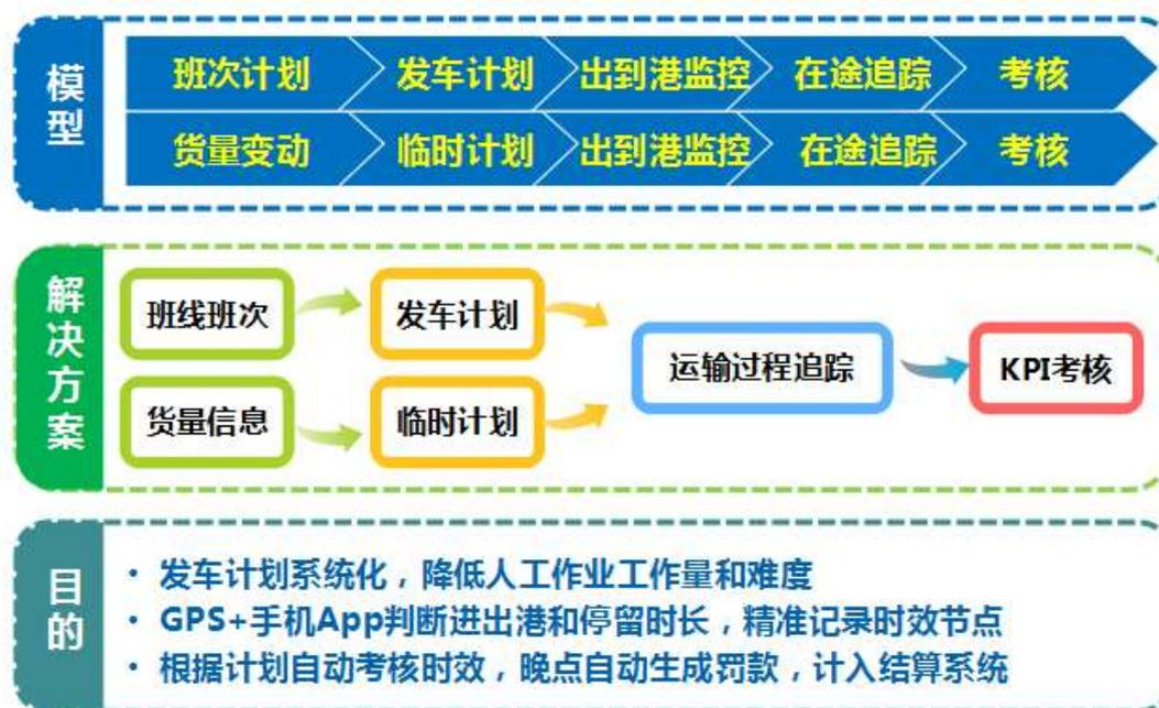
公司通过干线运输服务来协助物流运输企业的发车计划系统化，降低人工作业的工作量和难度；通过 GPS 和手机 App 来判断进出港和停留时间，精准记录时效节点；根据计划来自动考核时效，晚点会自动生成罚款，计入结算系统。
