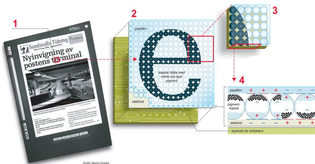
图：电子纸显示原理
