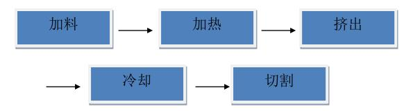
管材的生产过程主要是在挤出机内进行,公司采取的挤出机主要为螺杆式挤
