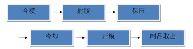
管件的生产技术主要是注塑成型,注塑过程的关键控制参数如下:
