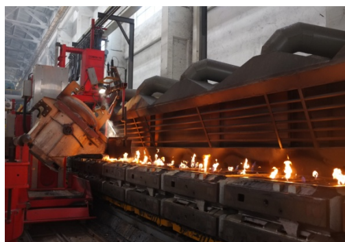
铸件自动生产线金属熔炼浇注现场
