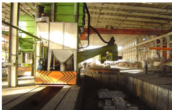
自硬呋喃树脂砂型砂/芯砂的配制与铸型/型芯制造现场
