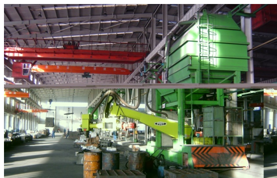
自硬呋喃树脂砂型砂/芯砂的配制与铸型/型芯制造现场
