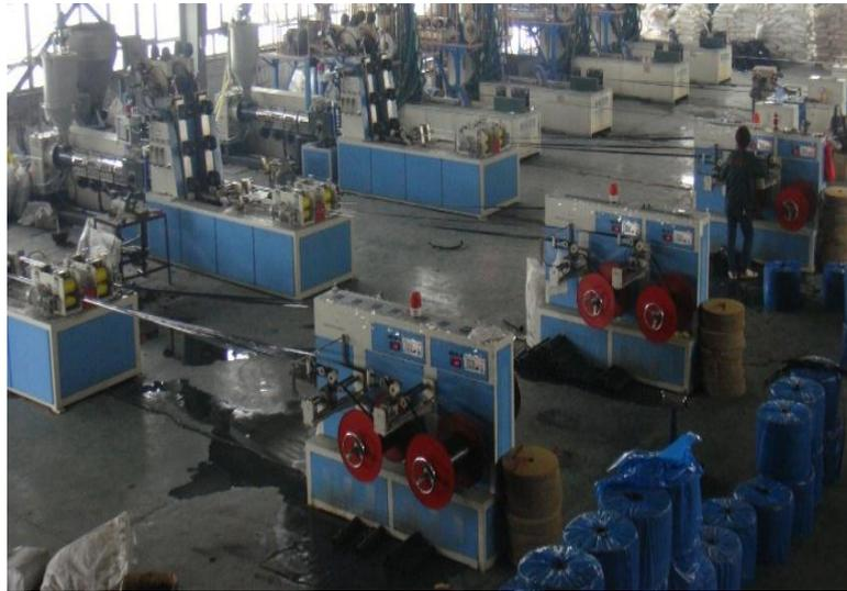
图 1 全自动一出四滴灌带成型装置
