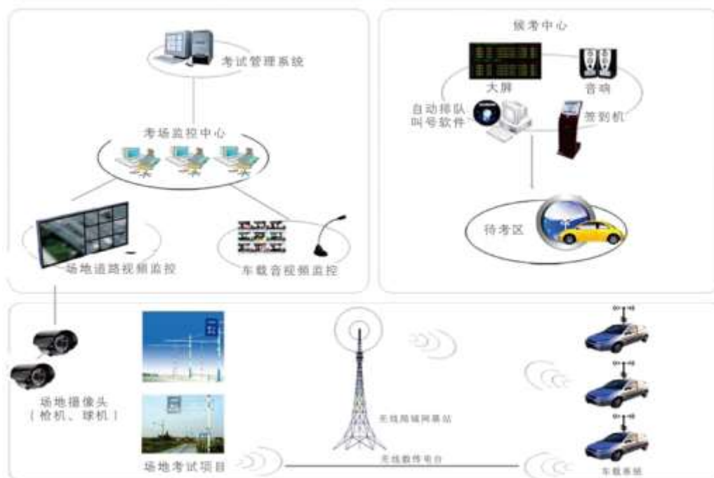
图 2-1: 机动车驾驶人智能考试系统图
