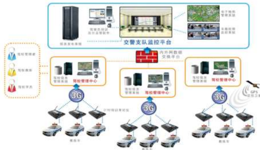
图 2-9： 车辆计时计程培训监管技术应用示例图
