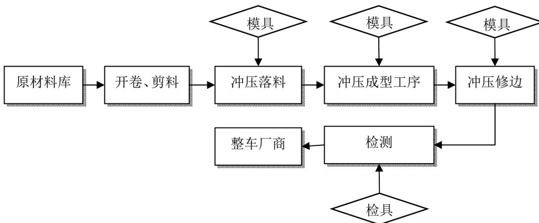
2、底盘冲压及焊接零部件的工艺流程
