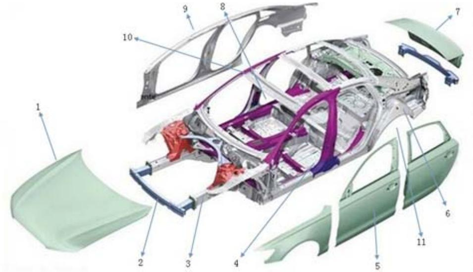
1、发动机盖总成；2、散热器冲压件；3、前围总成；4、门槛冲压件及侧围总成；5、四门总成；6、轮罩总成；7、尾门总成；8、地板冲压件；9、侧围总成；10、侧上外板及天窗冲压件；11、尾灯支架总成。
