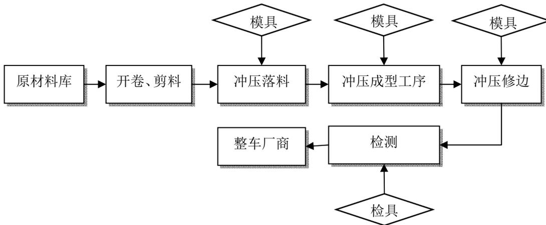
(2) 车身冲压及焊接零部件总成的工艺流程
