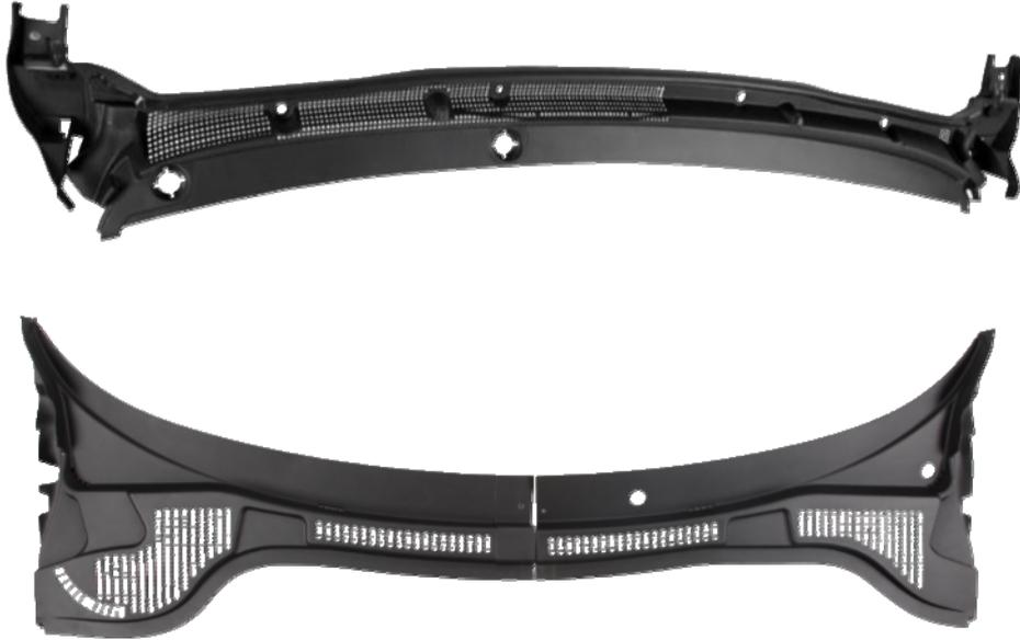
流水槽盖板总成是风挡玻璃与引擎盖间的外饰连接件，主要具有水管理功能和车内通风功能。水管理功能包含引导前挡玻璃外来水的流向、雨刮电机的防水及流水槽本体安装孔的防水；车内通风功能是指外界空气通过流水槽进入车体，输送至车内各个位置，并防止外来杂物进入空调进风口。
