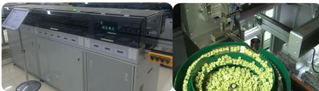
耐压试验单元自动封印单元
