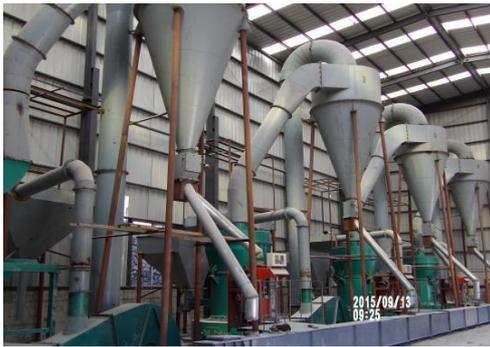
2015年11月10日，重钙粉生产线试车成功。该生产线可将石灰石或氧化钙磨成100~800目细度，用于环保脱硫或精细化工。
