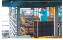
东方碳素智能化、立体化、全工艺、流水线式高纯石墨生产线于2016年投入运营,该系统将生焦煅烧-磨粉-混捏-轧片-凉料-二磨-成型等以前平面布置、相互隔离的生产环节彻底打通,实现了智能化控制、立体化建设、自动化流水线式生产。
