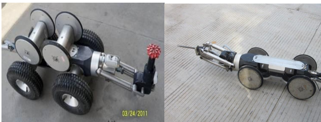
铣刀机器人切割头
