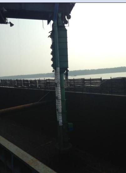
A photograph of a large industrial溜筒设备，连接在管道上。溜筒呈圆柱形，外表有保温层，连接在一些管道和支架之间。 | 装船机溜筒是干熄焦炭装船的关键设备，其制作、安装采用射线传感，通过计算机控制料柱高度、自动控制溜筒的落差，减少溜筒与焦炭之间的落差，由此来保证焦炭的完整性，同时该设备除尘装置完善，能有效减少焦炭装船过程中产生的灰尘。 |
