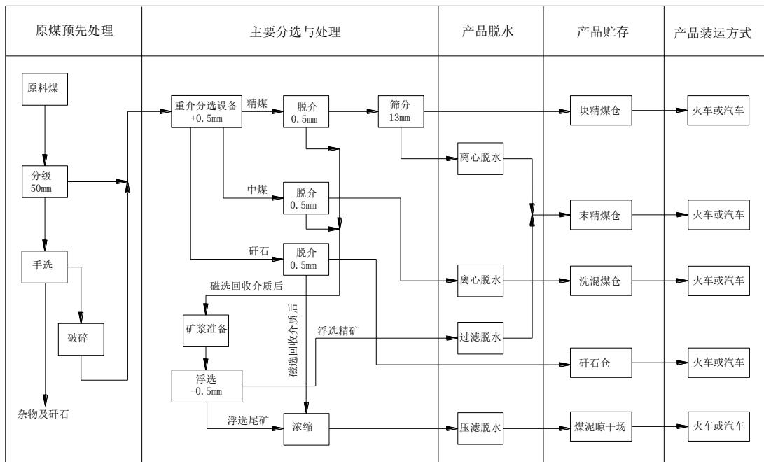
发行人煤炭业务流程如上图所示。原煤经预先分级，大于规定粒级经过人工捡杂后，破碎到规定粒级以下与原煤分级筛下原煤混合进入重介分选系统和浮选系统分选。重介分选设备分选出精煤、中煤、矸石三种产品。重介精煤、中煤、矸石经脱介、脱水后作为精煤、洗混煤、矸石等产品，经运输至相应的产品仓。重介精煤根据需要可筛分为不同粒级产品，主要分为块精煤和末精煤产品，并进入各自产品仓。细粒级煤炭经浮选工艺分选出浮选精矿和浮选尾矿，浮选精矿经过滤脱水后，作为精煤产品；浮选尾矿经浓缩、压滤后，作为煤泥产品。选煤厂的主要产品为精煤、洗混煤，辅助产品为煤泥、矸石，各种产品经过铁路、公路运输销售。
