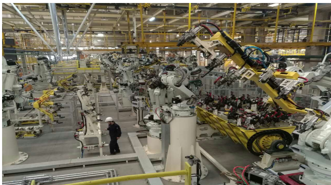
图示：白车身焊装自动化生产线
