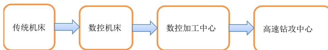
随着制造业结构的调整及升级需要、战略性新兴产业的壮大，信息化和工业化融合的趋势愈加明显，通用型数控加工中心已经难以满足部分 3C 行业的需求，因此数控加工中心开始向行业定制化方向发展，产生了针对 3C 行业的定制化的高速钻攻中心。
