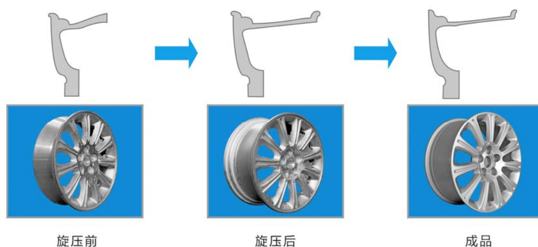
旋压制造工艺前后对比图
