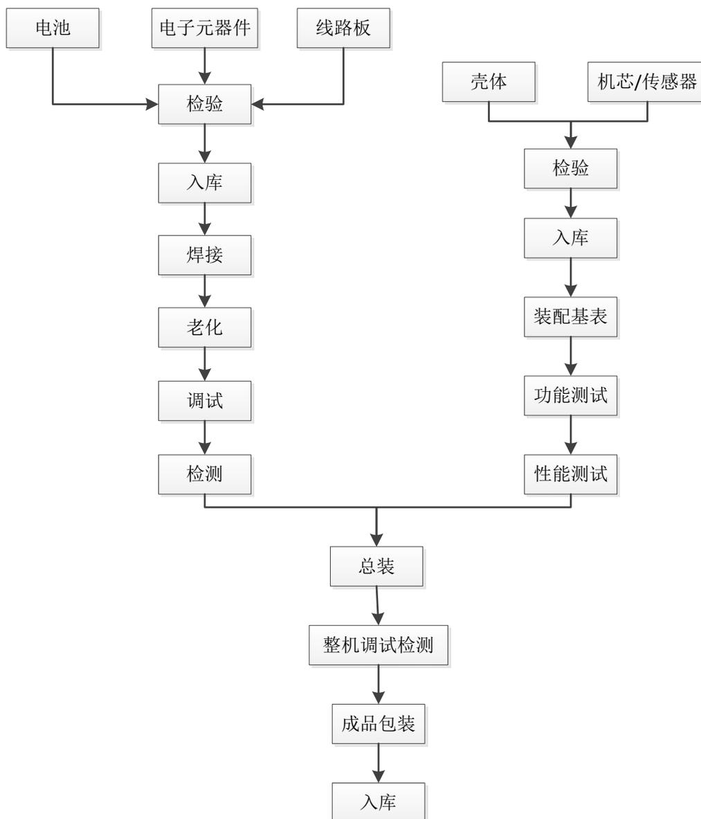
本项目在公司现有的各项先进工艺技术的基础上，重点对智能产品生产工艺全过程进行优化。线路板使用全自动印刷机、高速贴片机、双轨回流焊、焊接机器人或多工位焊接机等设备生产加工。加工完成的线路板进行 X 射线无损探伤检测机、AOI 自动光学检测仪及系列线路板（模块）功能测试装置等检测仪器检测确保产品质量可靠。
