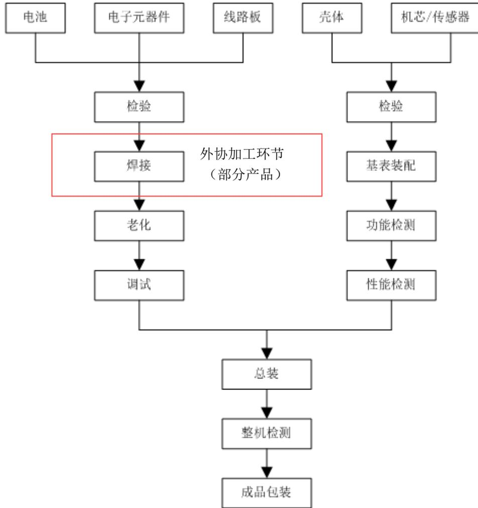
由于公司的水表产品属于计量器具，国家对水表计量有准确度等级和计量等级的标准，因此出厂前的整机检测环节尤为重要，是整个生产过程中的关键环节。
