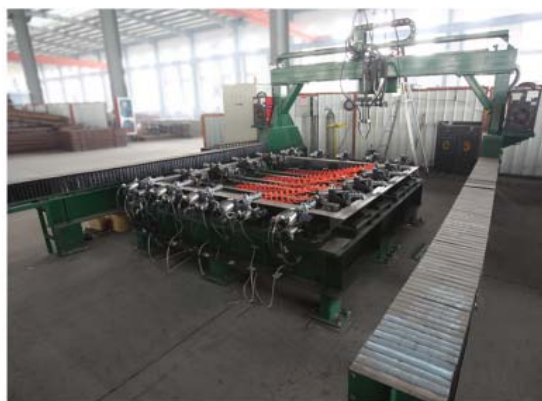
门框自动焊接线
