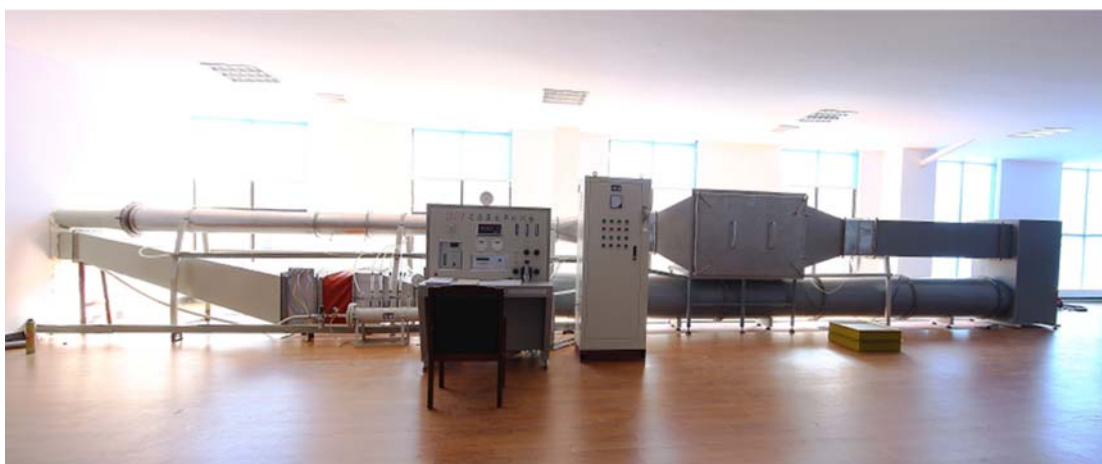
过滤吸收器钠焰检测台
