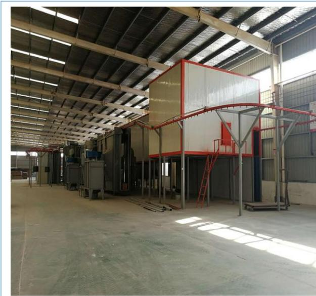
2017 年 11 月，公司子公司河南太极门业有限公司非标流水线建成。投产后产能可达 150 扇/天，较公司其它流水线生产出的门扇强度增加、防翘能力提高、外观更加漂亮。
