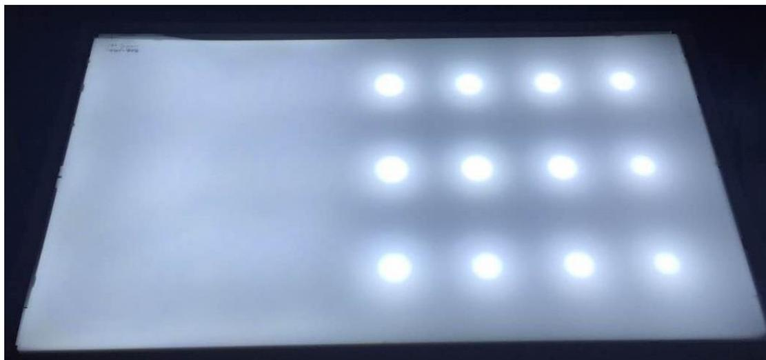
由上图可见，左侧使用光学透镜可以使发光更为发散，不产生光斑；右侧不使用光学透镜可以产生光斑。
