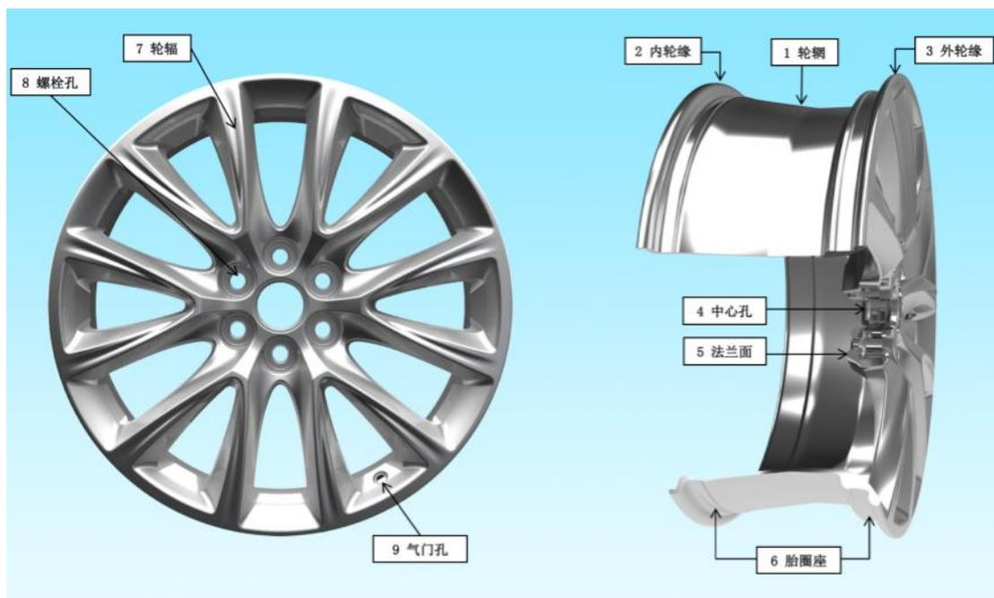
汽车车轮承受着车辆的垂直负荷、横向力、驱动（制动）扭矩及车辆在行驶过程中所产生的各种应力。由于车轮是高速回转运动的零件，因此要求其尺寸精度高，不平衡量小，支撑轮胎的轮辋外形（轮廓、尺寸、形状）准确，质量轻并具有一定的刚度、弹性和耐疲劳度。
