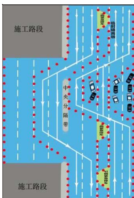
图 11-6-8 八车道通行能力双向三车道交通阻塞状况下的交通组织
