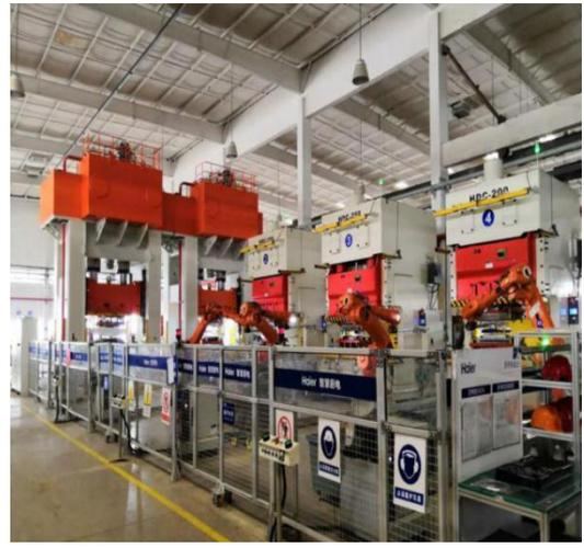
宇方凭借汽车行业良好的口碑和过硬的技术实力，竞标海尔智慧厨房电器有限公司的第一条燃气灶自动冲压线。此生产线效率达到家电行业最高--7S/件。从上料、涂油、冲压、检测、切边、去毛刺全过程自动化，整个流程全部采用6台ABB机器人实现。设计中充分采用自动化先进技术，应用了视觉检测对冲压的不良品进行检测。首创了机器人薄板自动打磨技术的运用。
