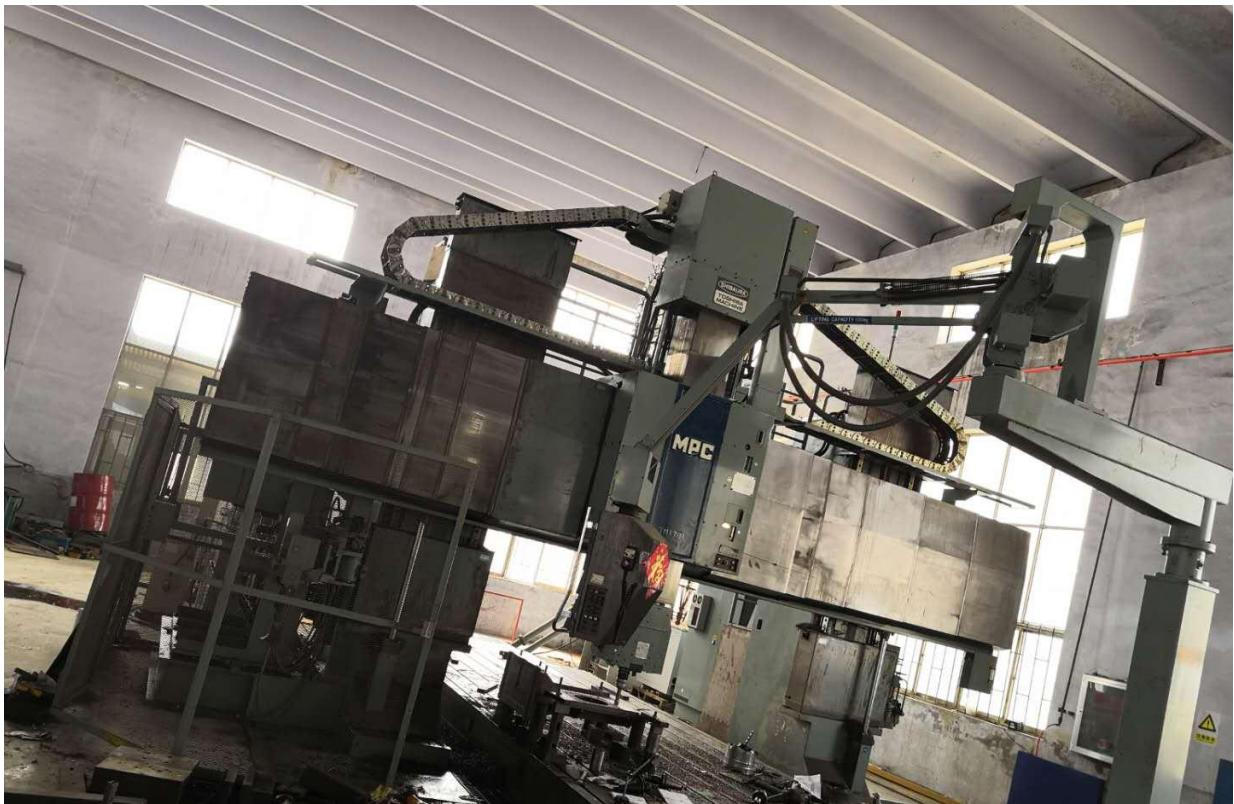
为提高生产效率，公司特付款 260 余万元购买一台龙门五面体加工中心机，该加工中心加工的零部件大大提高了加工精度。
