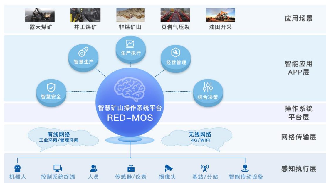
智慧矿山工业物联网架构图
