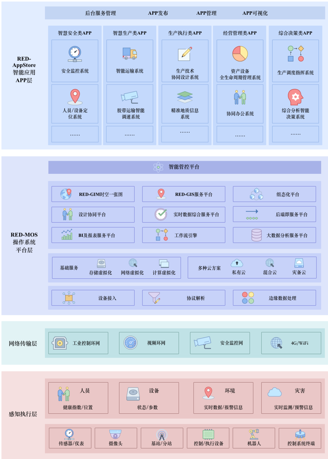
华夏天信能源工业物联网四层架构体系
