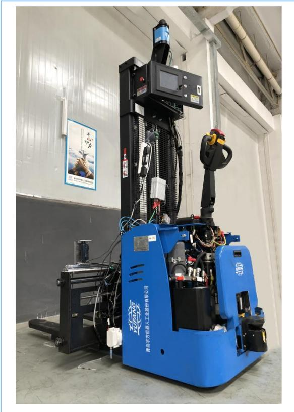
2019年3月，我公司与上海通用联合注资研发“自动调整叉齿位置及自动料箱定位叉车”。这是上汽通用根据仓库实际应用过程中一直没有解决的痛点提出的一个研发需求，这种叉车需要解决两点问题，一是高位货位料箱的定位，叉车需要根据料箱的定位调整叉车的位置以及叉齿的位置，以配合料箱的准确插取；二是需要解决叉车在高位插取时，需要定位叉车门架的弯曲程度，以补偿叉齿的角度和位置。上汽通用仓库物流大量使用了高位叉车，有迫切的应用需求。目前，研发测试有序进行。预计2019年底，产品下线实现量产。
