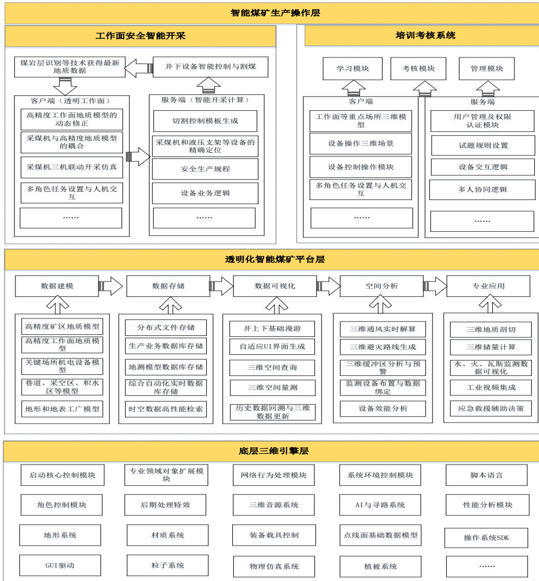
图 9-4 透明化工作面管控平台架构设计
