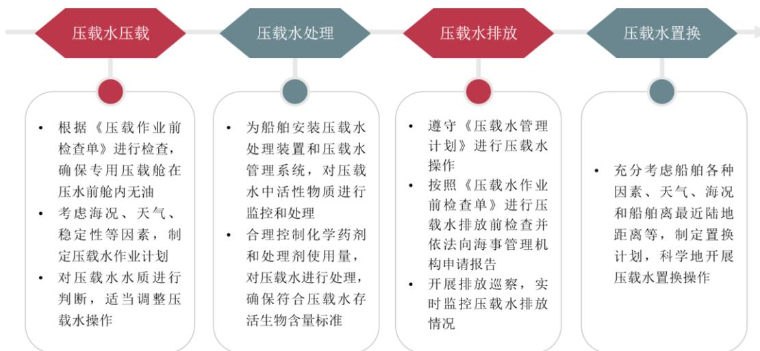
图注：压载水压载、处理、排放、置换等环节操作要求
