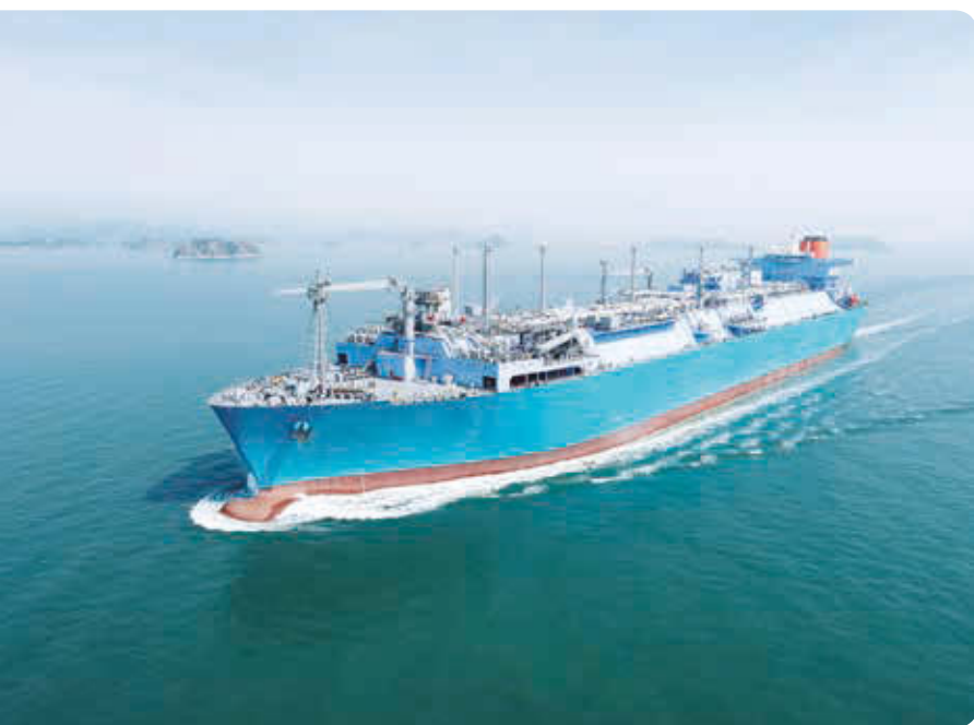
▲ 海上液化天然氣接收站採用的浮式儲存再氣化裝置船，配備有液化天然氣缸及再氣化裝置。
