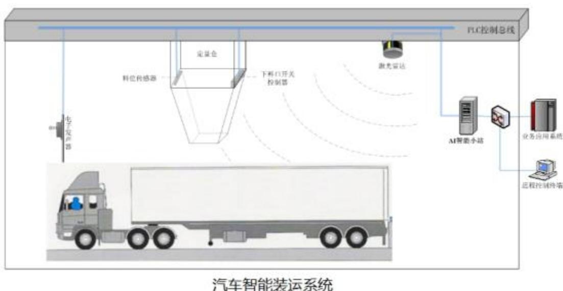
矩阵软件汽车智能装运系统工作场景如上图示意，通常在货仓通道前端安装电子发声器，适时语音提示货车司机配合操作；系统通过 PLC 控制总线采集定量仓中料位传感器数据，并可通过控制器开关下料口；一般在货仓通道的后上方安装激光雷达，实时采集并形成装车全过程点云数据；现场配置的 AI 智能小站中运行矩阵软件自动装车智能检测算法(Matrix-LoadDetector)，它依据雷达点云数据，并结合定量仓料位数据，实时计算车厢边缘位置和物料装载状态，预判出下一步货车司机应采取的操作，并通过电子发声器提示出来。系统可以通过接口向业务应用系统交换装车数据；并配有远程控制终端，操作人员可以实时监控装车过程，并可在必要时介入控制装车过程。
