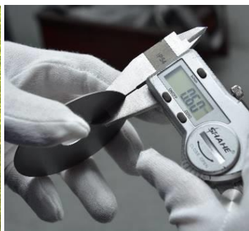
上图为超细超薄圆片，厚度仅为 0.6 毫米。
