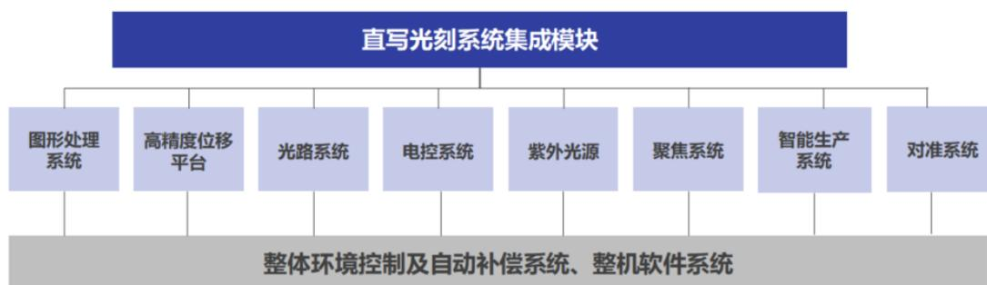
上述各子系统对应发行人的PCB直接成像设备及泛半导体直写光刻设备的结构如下：
