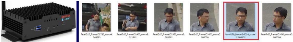
基于轻量级卷积神经网络模型的多路视频流人脸抓拍边缘设备
