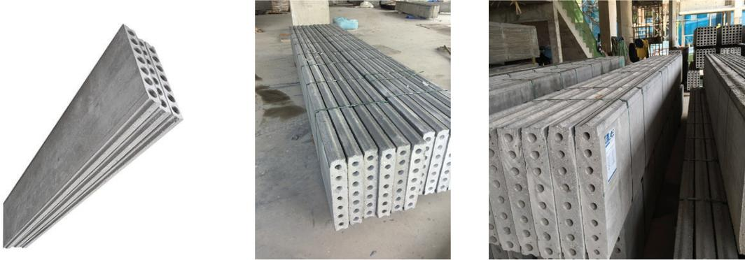
標準預製混凝土牆板的板身設有七個垂直的空心孔洞，主要目的為減低重量和面板內的材料，但同時保持強度。空心孔洞亦可在需要安裝電線、鋼絲、管樁和管道時提供空間，而毋須切斷或影響面板的結構完整性，繼而可為建築師或工程師的機電設計及安裝提供更大的靈活性。
