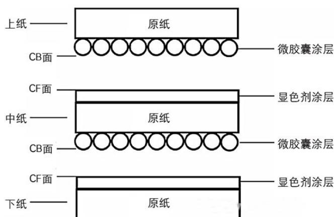
用钢笔、铅笔、打字机键或其它书写工具在上纸用力时 CB 面微胶囊破裂，释放出其中的无色染料前体（电子给体）与 CF 纸上的显色剂（吸引电子）发生显色反应而显现颜色。
