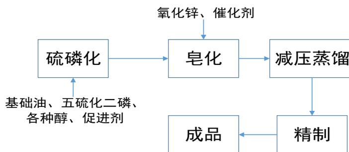
公司生产多种不同结构的抗氧抗腐剂产品，主要以原料 C3~C14 醇、基础油按一定比例混匀与五硫化二磷在 80~100℃反应，生成的硫磷酸再与氧化锌在 80~100℃反应。经蒸馏、精制，得到抗氧抗腐剂产品。
