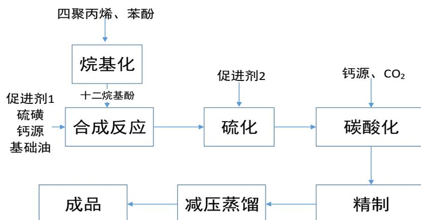
该产品主要将苯酚、四聚丙烯等投入反应釜经系列反应后生成十二烷基酚，十二烷基酚与基础油、硫磺、氧化钙等在合成釜进行中和反应，中和反应结束后在促进剂作用下进行硫化反应，之后加入二氧化碳气体、钙源进行碳酸化反应，反应结束后再经精制、减压蒸馏等得到硫化烷基酚钙成品。
