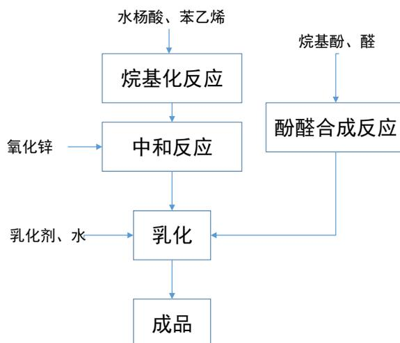
公司目前主要生产水杨酸类无碳纸显色剂，主要以水杨酸、苯乙烯为主要原材料经过合成、乳化制成。水杨酸和苯乙烯在催化剂的作用下生成的芳烷基取代水杨酸与多价金属化合物进行反应，反应温度为 50~200℃，时间 15-20 小时，反应完成后经过精制得到改性芳烷基取代水杨酸树脂多价金属盐。乳化过程中，采用特殊的加料模式，使乳化出的显色剂粒子的平均粒径处于可控范围内，生产出来的改性水杨酸锌树脂乳液既有低温显色速度快、色泽鲜艳的优点，又有显色浓度深、字迹光老化性能优良、涂层光老化不易变黄等优点。
