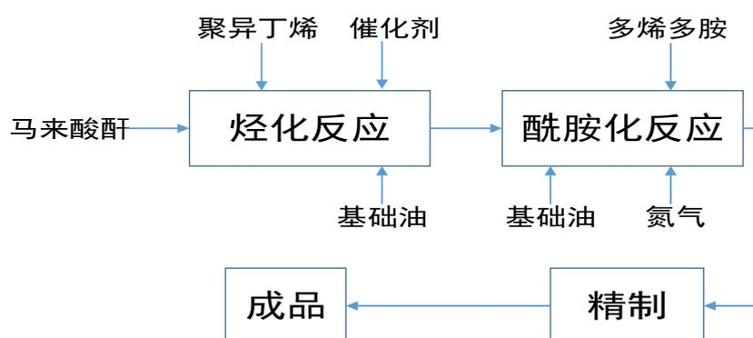
公司分散剂采用催化热加合法生产工艺生产，以聚异丁烯、马来酸酐、多烯多胺为主要原料，经烃化反应和胺化反应制成。
