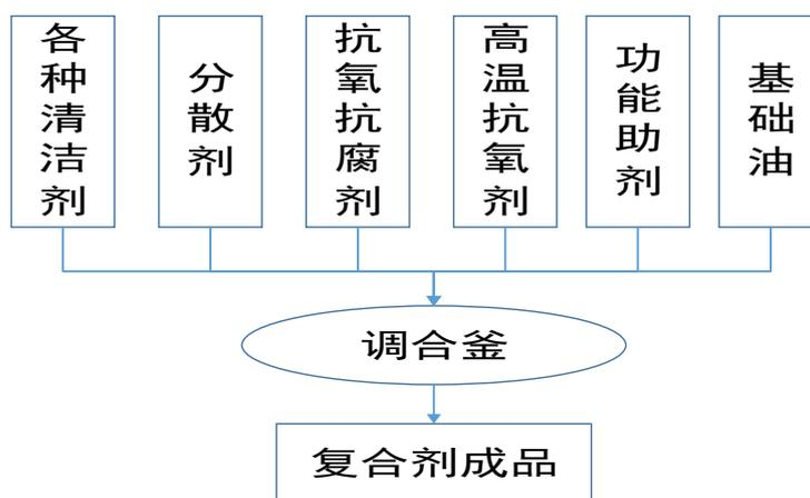
2013 年起公司开始涉足复合剂产品的调制。按照产品配方和工艺要求，将各种润滑油添加剂单剂及功能助剂、基础油等加入调和釜，经搅拌调和制成。
