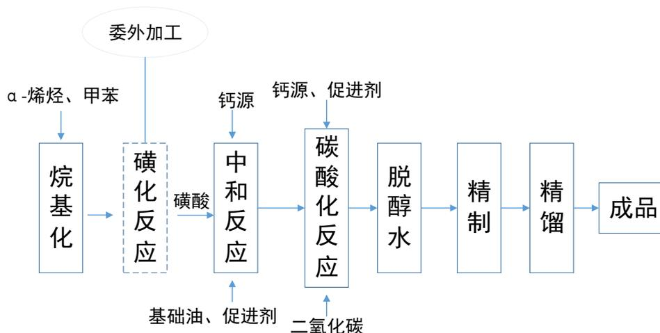
公司目前能够生产低、中、高、超高碱性磺酸盐类清净剂。该产品主要将烷基化和磺化之后生成的磺酸（少部分磺酸公司直接外购）与促进剂、基础油、钙源（氧化钙）等原料依次加入反应釜中，控制一定的反应温度进行中和反应，然后在一定的温度条件下，向反应釜中通入一定流量的二氧化碳，进行高碱碳酸化反应，待高碱碳酸化反应结束，再进行精制、精馏等生产工序得到最终产品。
