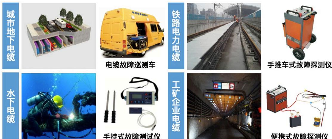
图6.1.7 电力电缆故障探测与定位装置主要类型示意图
