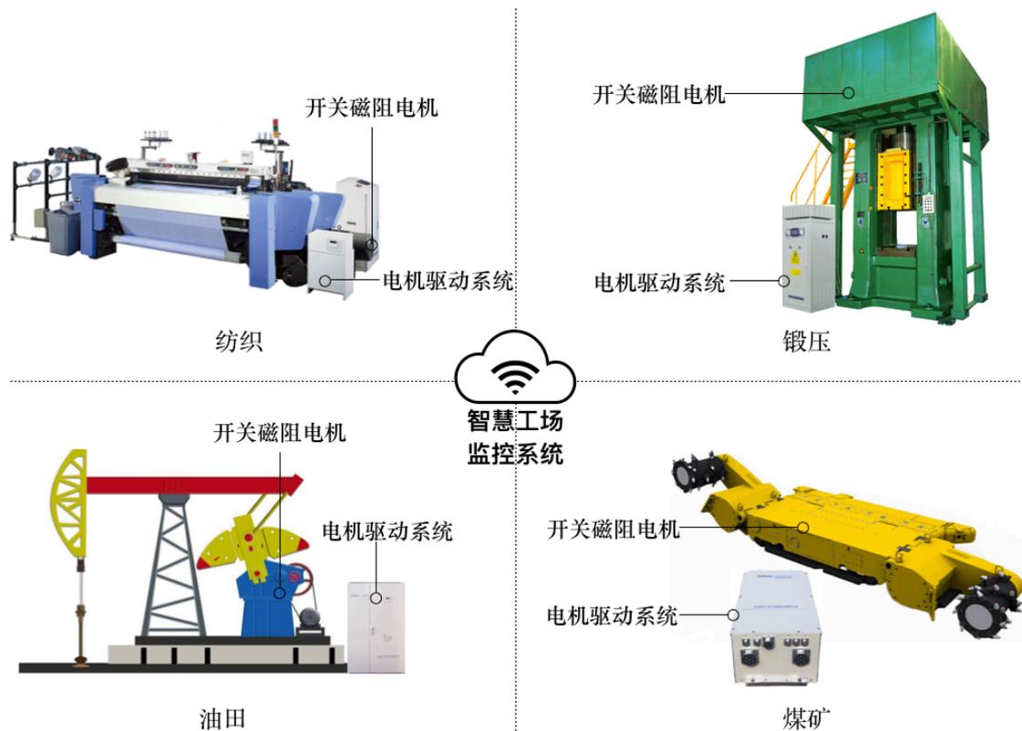
图 6.1.9 开关磁阻电机及其驱动主要应用场景示意图
