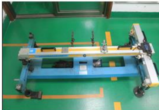
BDQ-1 型轨道检查仪标定器
