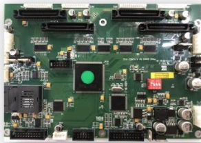
针对理光喷头开发的打印控制卡
