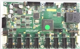
针对北极星喷头开发的打印控制卡
