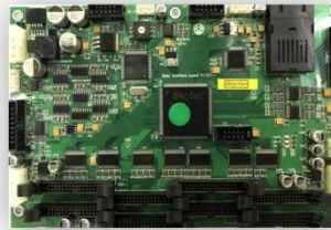
针对京瓷喷头开发的打印控制卡
