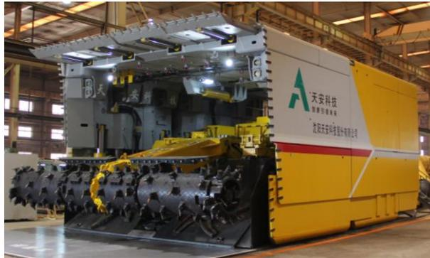
1、“大断面矩形煤巷盾构式快速掘进机器人系统”于2020年5月27日成功下线。这是沈阳天安科技股份有限公司承接的陕西煤业化工集团有限责任公司重点研发项目“煤矿巷道快速掘进机器人系统研发与示范应用”中的核心子项目，该装备主要应用于大型矿井长距离煤巷的智能化掘进。作为国内首套“大断面矩形煤巷盾构式快速掘进机器人系统”，该装备成功研制将进一步推动煤矿掘进作业的“智能化”、“无人化”发展，是我国煤矿掘进技术与装备的一大创新，在国内掘进装备发展历程中具有重要意义。
