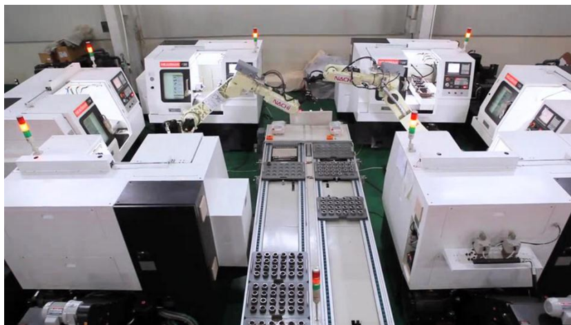
汽车球壳自动化生产线
