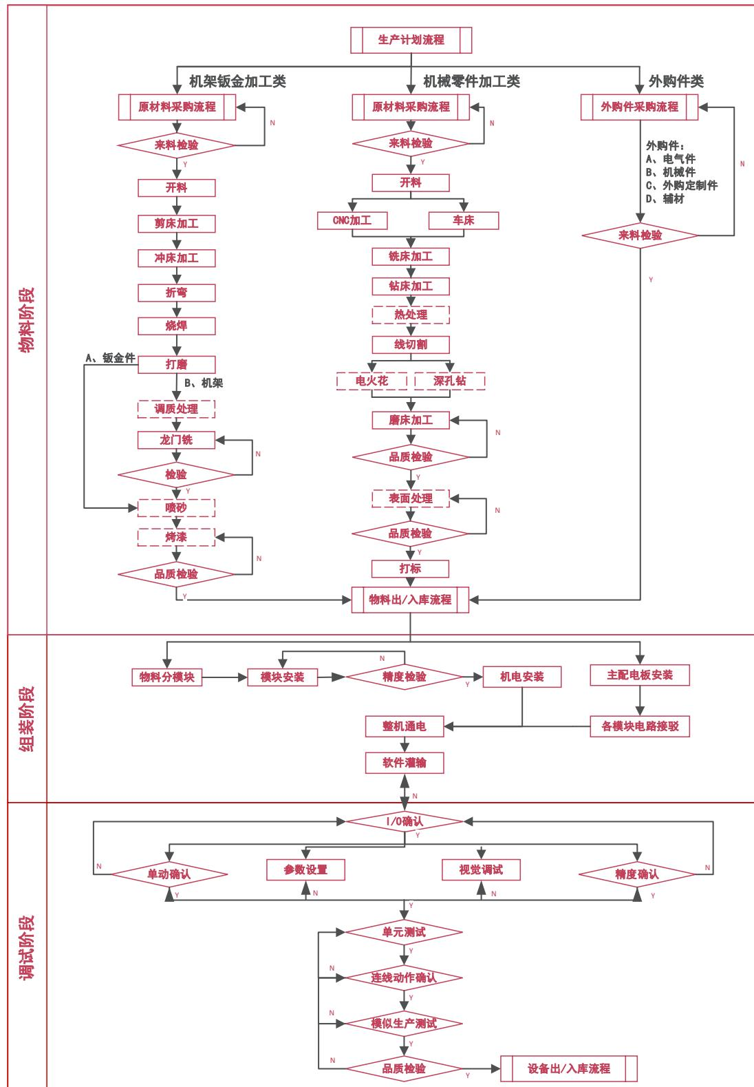
注：1、物料阶段虚线框中的工序发行人全部通过外协完成；其余工序主要由发行人自主完成，同时综合考虑生产订单排期、自身生产能力等因素部分交由外协厂商完成；2、组装阶段“软件灌输”由发行人自主完成；其余工序主要由发行人自主完成，同时根据需要也会采用劳务外包的方式完成；3、调试阶段全部由发行人自主完成。
