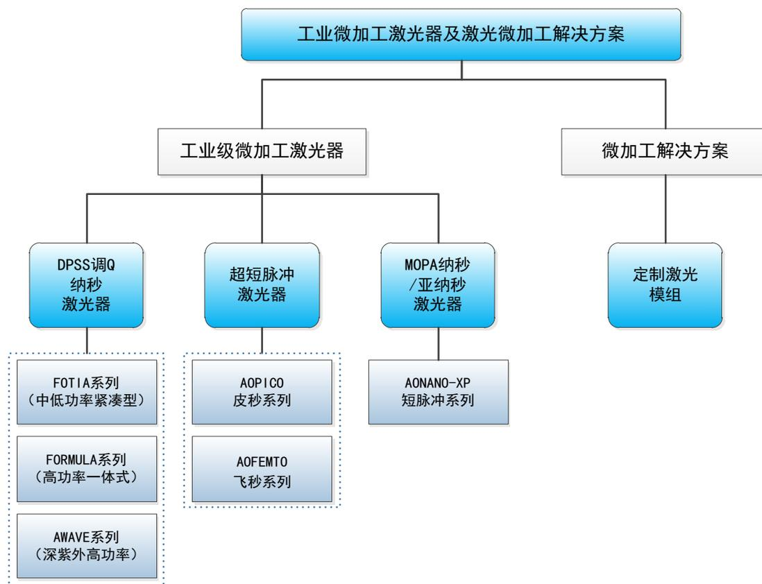
公司 DPSS 调 Q 纳秒激光器按适用功率和结构可分为 FOTIA、FORMULA、AWAVE 三个系列，其中 FOTIA 系列为紧凑型中低功率激光器，FORMULA 系列为一体式高功率激光器，AWAVE 系列为深紫外及定制化激光器；超短脉冲激光器分为 AOPICO 皮秒系列和 AOFEMTO 飞秒系列；此外，公司会根据客户需求定制设计激光模组，提供激光微加工解决方案。主要产品描述如下：
