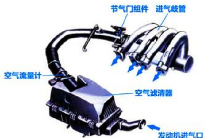
汽车发动机进气系统结构示意图
