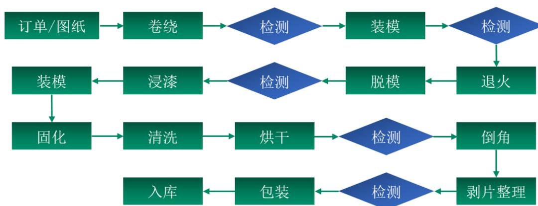
在非晶及纳米晶铁心的生产过程中，主要涉及卷绕、装模、退火、浸漆、固化、倒角（切割）及检测等核心工艺，其涉及的主要生产设备及其主要功能如下：
