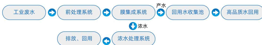
在工业废水零排放领域，公司技术的主要目标是实现工业废水深度处理过程中的减量化、资源化。通过有效分离工业废水中杂质和有机污染物，使经过上述技术处理后的工业废水能够进行有效回用，同时降低工业废水深度处理过程中的能耗。公司依靠自主研发的“连续超滤过滤工艺+纳滤分盐工艺+高效电渗析及高压反渗透工艺”实现对工业废水进行深度处理，提高回用效率和资源化利用。对浓缩处理后的少量高含盐量浓水进行蒸发结晶，可显著降低蒸发结晶单元投资和运行费用。
