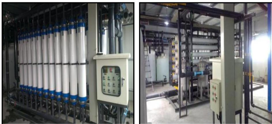
该项目共七期，总处理水量 42,000m<sup>3</sup>/d，原水为生产污水经处理后的达标排放水，项目采用“砂滤+超滤+反渗透”相结合的工艺，项目高品质产水回用至生产车间。该项目得到了客户的肯定，公司与客户持续保持着良好的合作关系。
