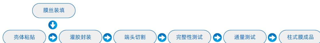
柱式膜元件生产流程图
