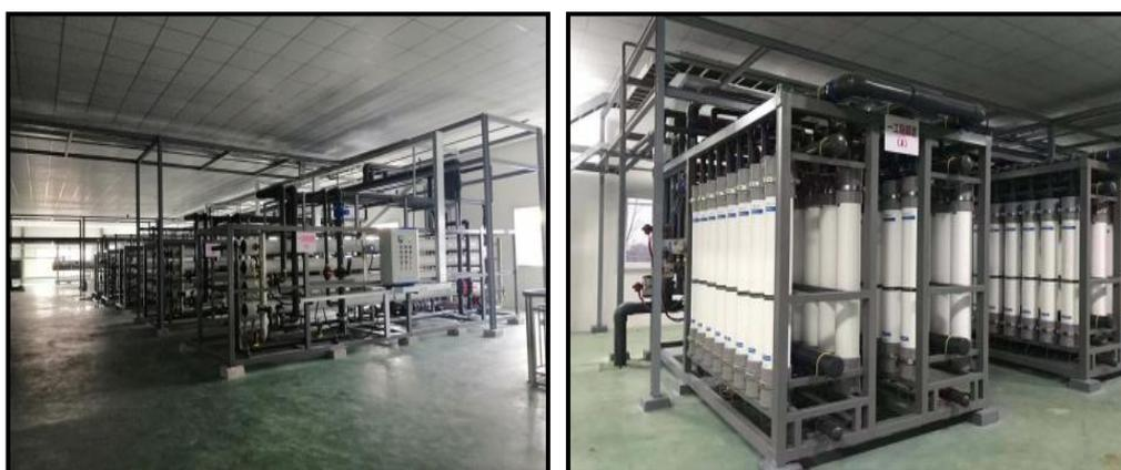
该项目处理的工业废水具有高 COD 和高碱度的特点，盐分主要以氯化盐为主，来水水质变化大。该项目采用“预处理+膜技术处理+蒸发结晶技术”相结合的工艺，项目实施后能够实现工业废水的再生回用、硫酸钠结晶盐作为元明粉回
