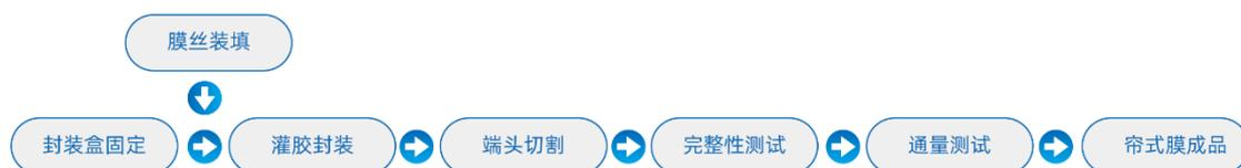
帘式膜元件生产流程图
