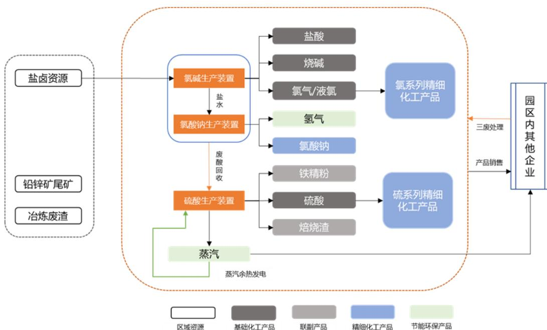
公司始终坚持经济效益、社会效益和环境效益同时发展,现已形成完整的循环经济产业链。在氯化工产品链方面,公司以工业盐为原材料生产烧碱和氯酸钠,同时在生产中产生的液氯可用于制造三氯化铝、三氯化磷、结晶氯化铝等精细化产品,产生的氢气供园区企业作为双氧水的主要原材料;在硫化工产品链方面,
