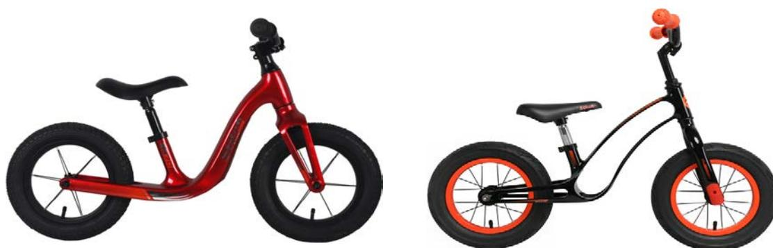
在安全性方面，公司设计开发的小趣一代儿童自行车和滑步车，采用自润滑转动设计，改变传统童车传动及转动方式，常规自行车使用的是钢珠转动系统，其使用寿命较短，磨损之后自行车的传动变得极为费力，设计优化之后有效解决此类问题，并提高了童车使用寿命；此外，公司采用全封闭系统设计的童车，整车全包覆无尖锐突出物，使自行车变得更简洁美观的同时，更保障了儿童的骑行安全。产品示意图如下：
